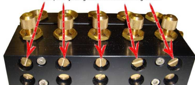
Beispiel Stellschrauben für Mediumregulierung / example adjusting screw for medium regulation
